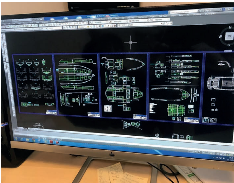
Door een exploded view te maken zijn alle onderdelen goed zichtbaar.
