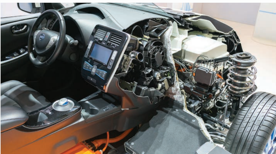
Lange glasvezel PP is populair bij metaalvervanging in de automobielsector, te vertalen in gewichtsbesparingen. De in de automobielsector ingezette LGF PP materialen vinden we terug in instrumentpanelen, deuren, raammechanismen, de middenconsole, de versnellingspook en zelfs in pedaalsets.
