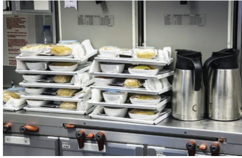
De combinatie van transparantie en weerstand tegen oliën, vetten en schoonmaakmiddelen maken SAN zeer geschikt voor gebruik in de keuken. Een veel voorkomende toepassing is servies voor de vliegtuigindustrie.
