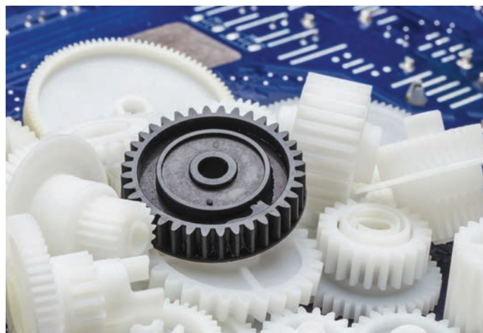
De zelfsmurende eigenschappen maken Nylon uitermate geschikt voor tandwielen en lagers.
